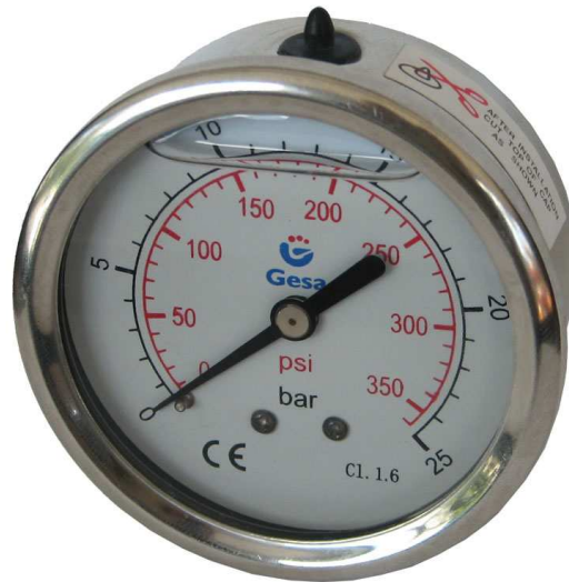
Rys. 39. Widok manometru klasy 1.6, wypełnionego gliceryną, z podwójną podziałką, wyskalowaną w różnych jednostkach bar i psi (Pound per square inch – psi jest to jednostka pochodna ciśnienia w brytyjskim systemie miar) [30]
